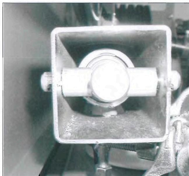
Рис. 7.2 Срезной штифт на штанге гидроцилиндра подачи
