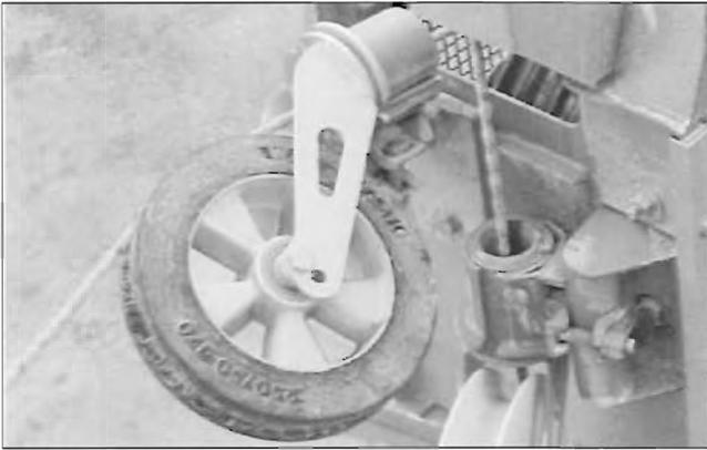
Рис. 5.6 Верхний (транспортный) отводящий ролик выровнен
