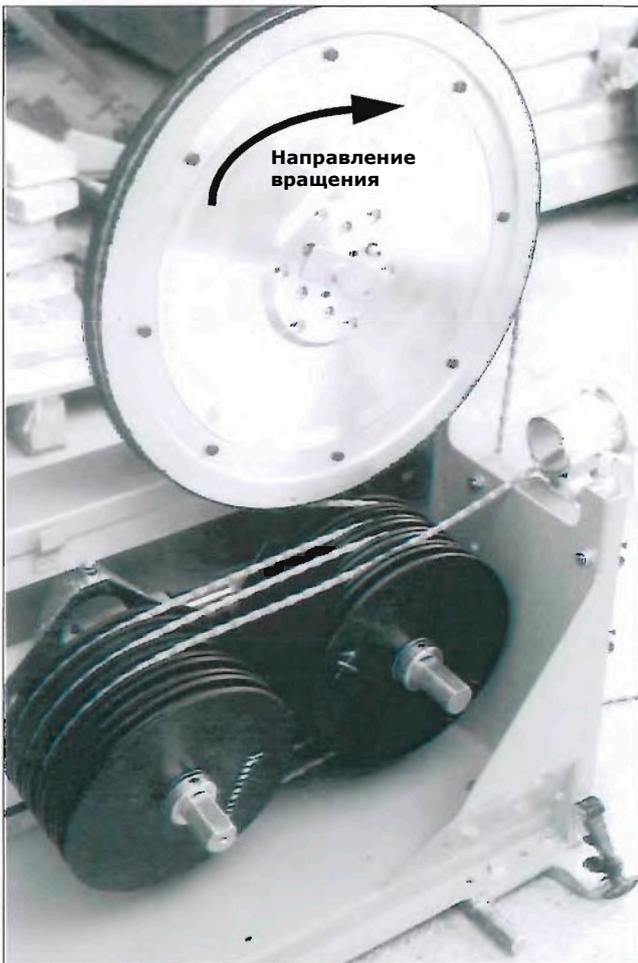
Рис. 5.7 Открытый канатная система (канат уложен)
