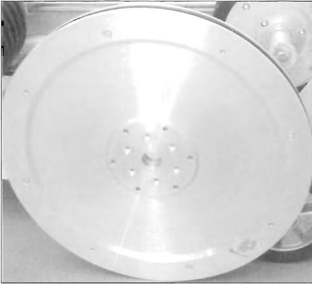
Рис. 8.4 Приводное колесо каната
