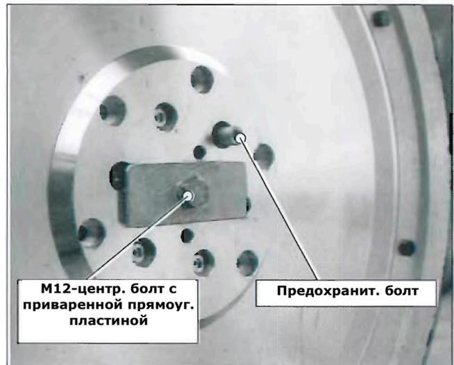
Рис. 5.3 Смонтированное приводное колесо с предохранительным болтом
