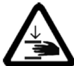
Машина, коронка и сверлильная станина имеют большой вес - угроза быть раздавленным
