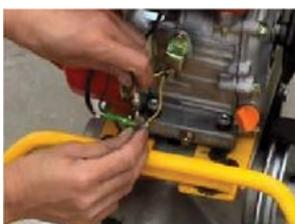
**ШАГ 3:** Прикрепите проволоку, идущую от блока ручки, к двигателю при помощи специального соединителя, который входит в комплект поставки нижнего блока.
